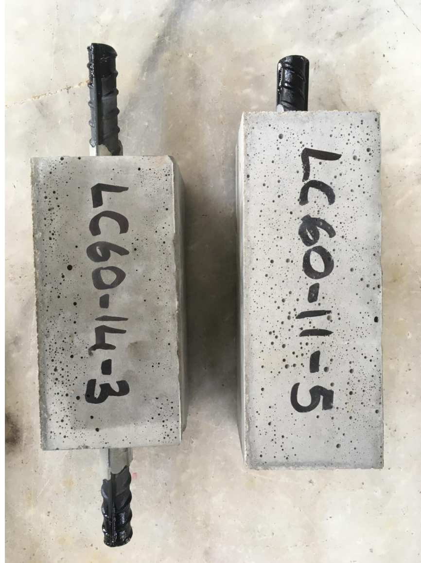
İki ucundan ve tek ucundan donatı çıkmıř numuneler
