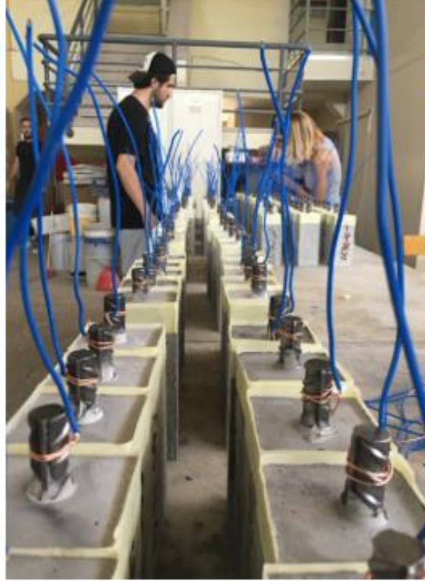
Donatı uçlarına bakır kablo bağlanması ve avometre ile temasın kontrolü
