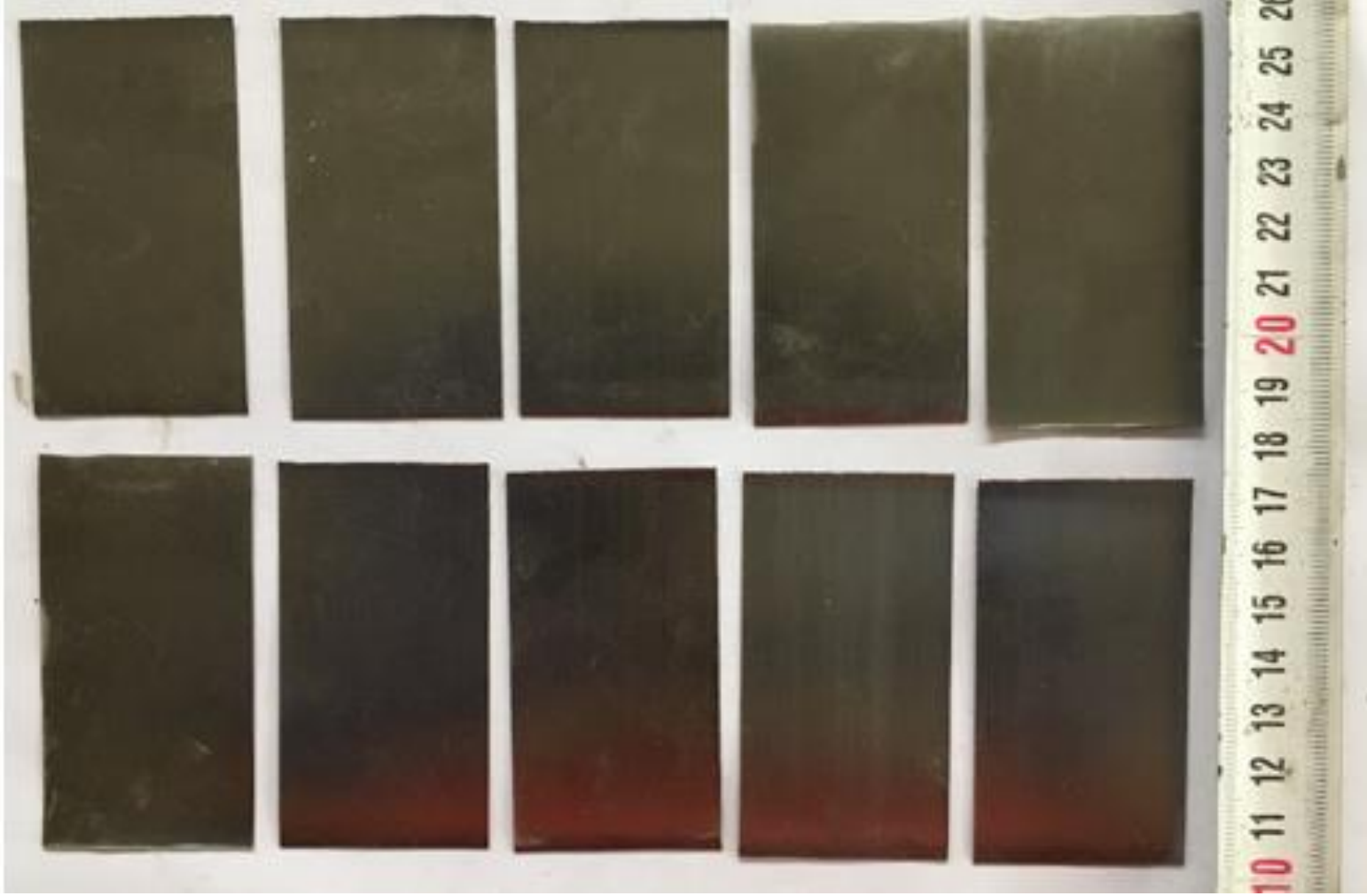
Yapay atlaklı Numunelerin Hazırlanması
