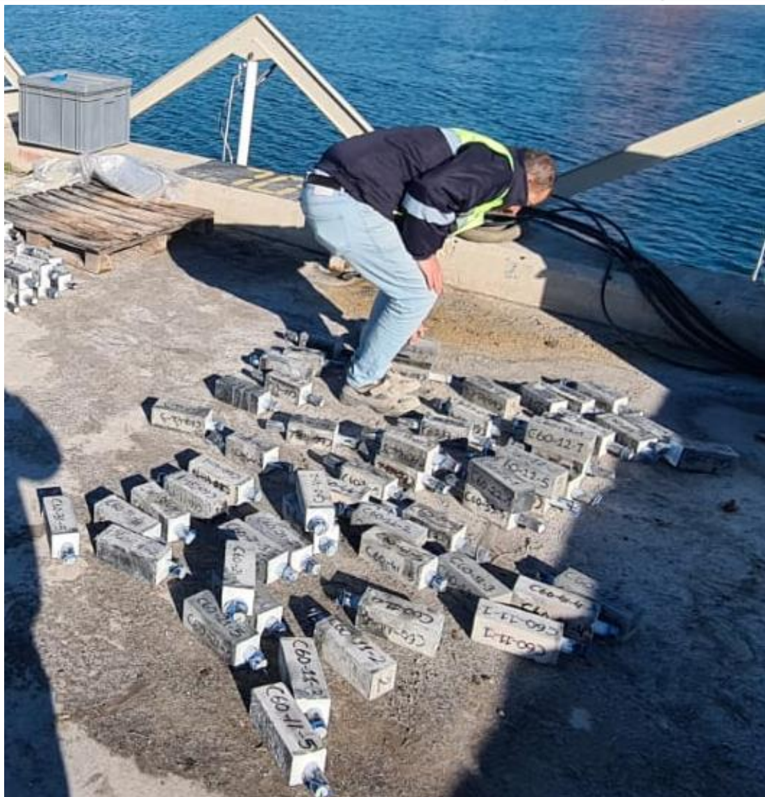
Numunelerin Islanma-Kuruma Platformuna Yerleřtirilmesi
