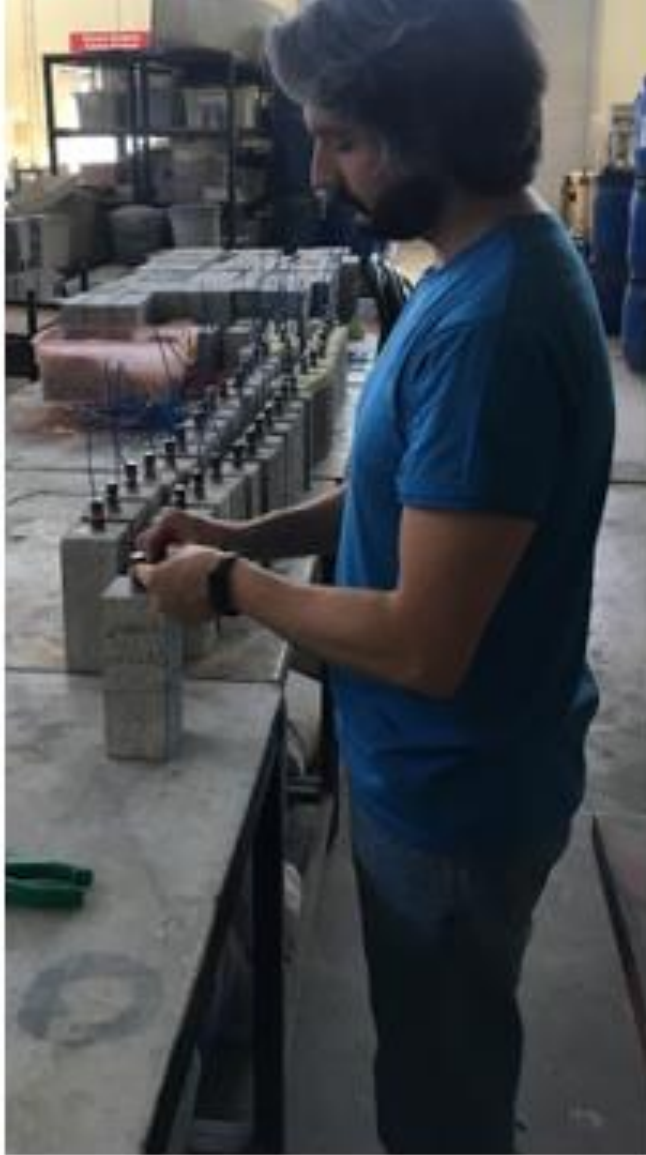
Donatı uçlarına bakır kablo bağlanması ve avometre ile temasın kontrolü
