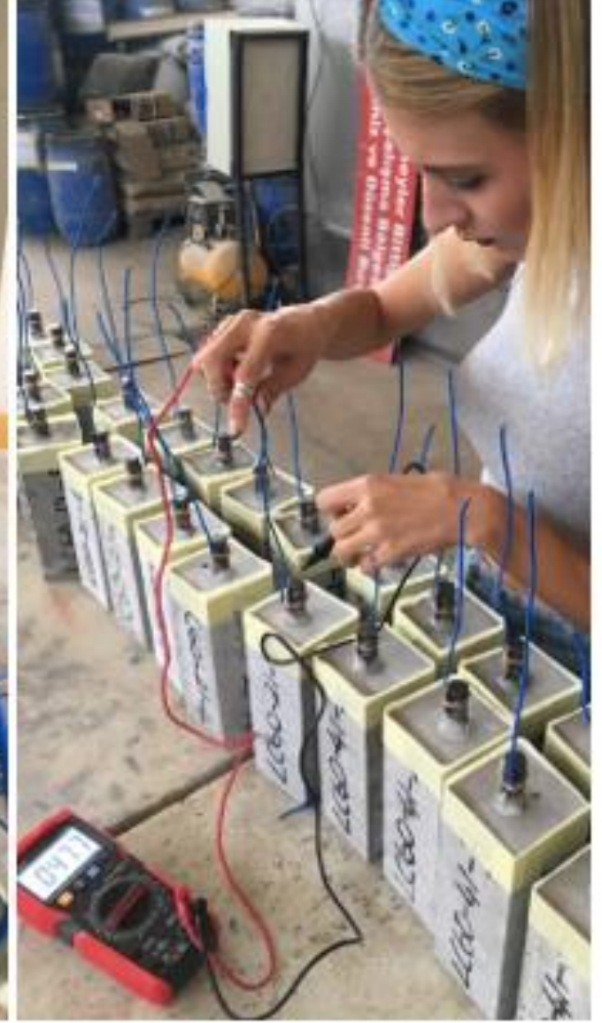
Donatı uçlarına bakır kablo bağlanması ve avometre ile temasın kontrolü
