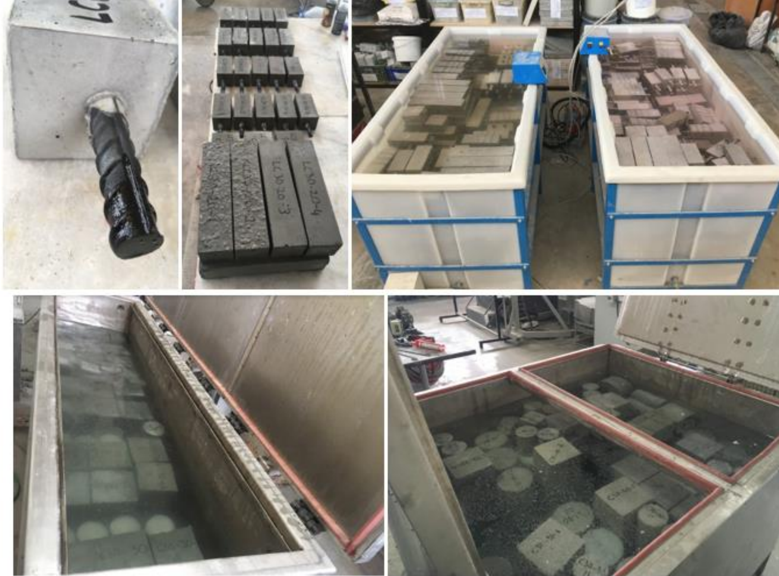
Açıkta kalan donatıların epoksi kaplanması ve tüm numunelerin kür işlemleri
