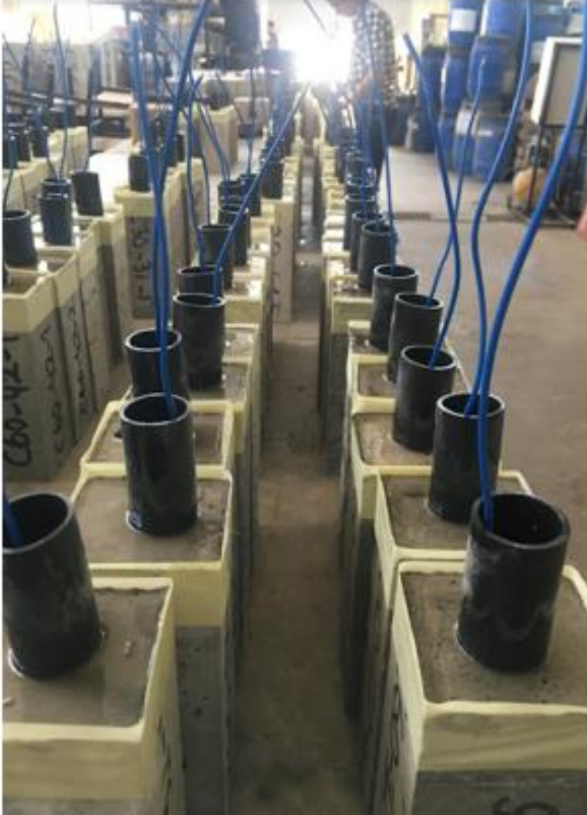
Donatılı numunelerin epoksi ile yalıtımının sađlanması
